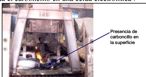
Figura 2: Presencia de carboncillo sobre la superficie del baño electrolítico.
